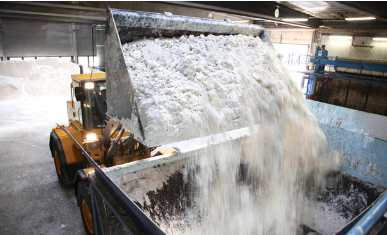
Återvunnet slam från aluminiumindustrin blir vattenreningsprodukter. En cirkulär lösning som är hållbar!
